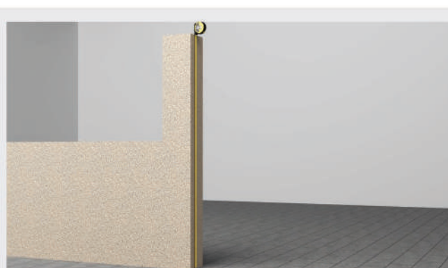
6 Prendre la hauteur des 2 piliers, retenir la plus petite mesure et déduire 7cm pour la fixation des éléments de guidage; Measure the height of the two pillars. Consider the smallest height and deduct 7 cm for the installation of the fixing elements;
