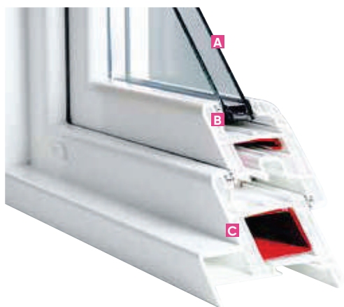
A Double vitrage 4 ITR/20/4 B Ouvrant et C DORMANT : 5 chambres chacun pour une bonne isolation - renforts EN OPTION (parties rouges sur la photo)
